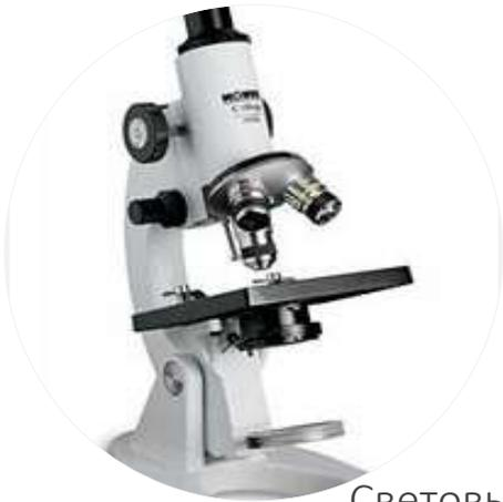
Световые микроскопы предназначены для изучения микроорганизмов, которые имеют размеры не менее 0,2 мкм (бактерии, простейшие)
